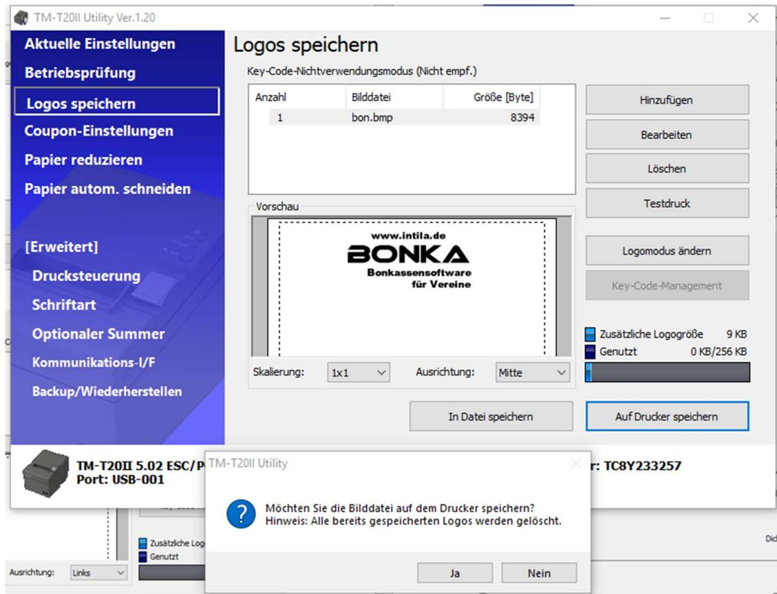
Fertig. Mit Testdruck kann der Druck getestet werden.
